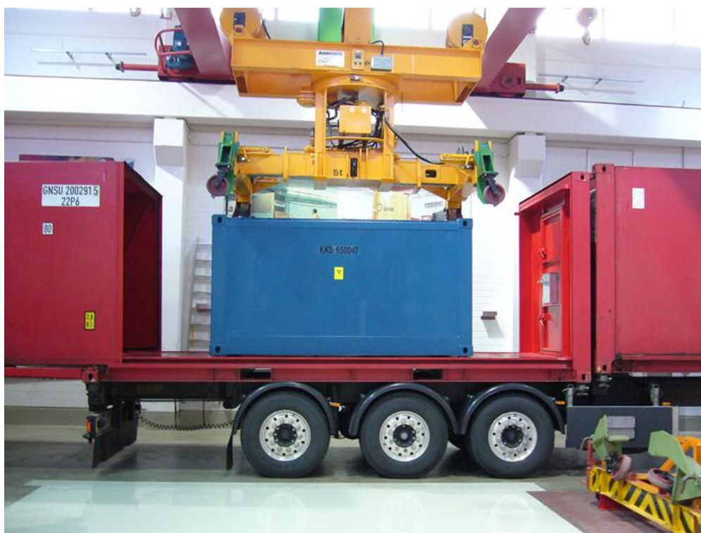
Abb. 16: 20'-Container mit Endlager-Container auf LKW
