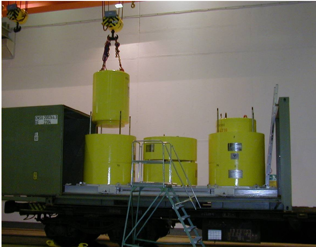
Abb. 19: Gussbehälter als Typ B-Versandstück im 20'-Container
